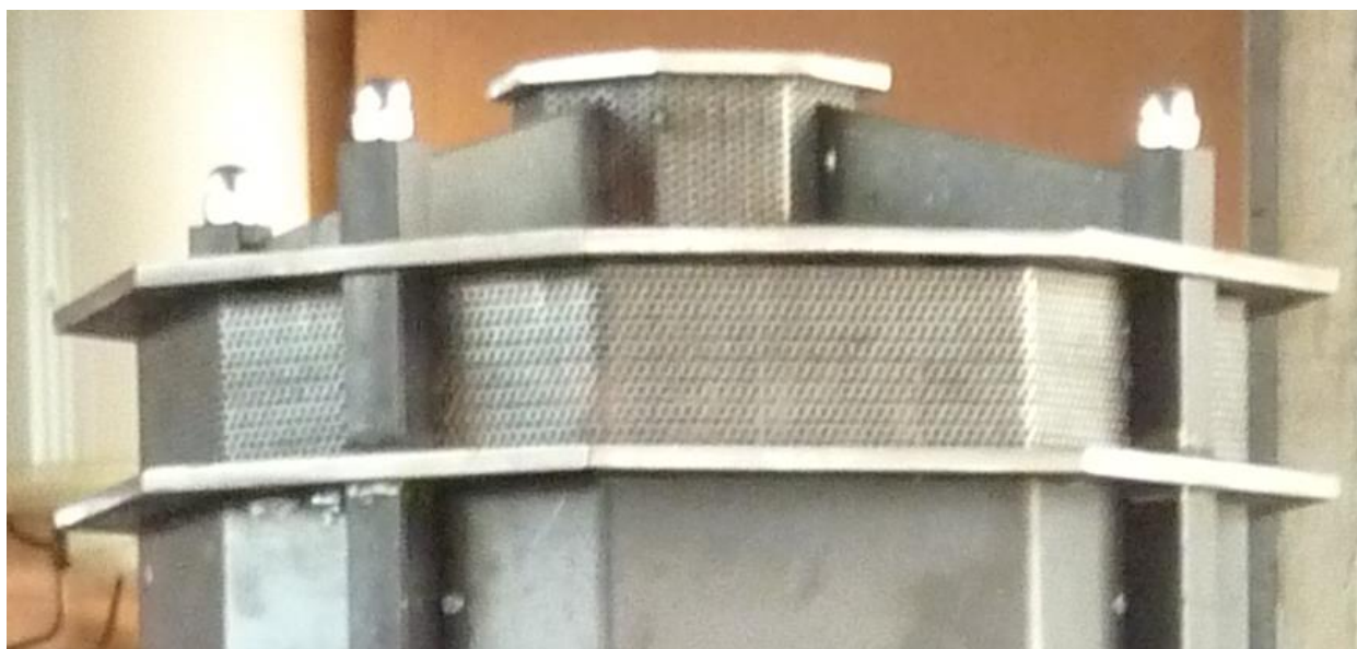
Le détail du couronnement, bombé à la presse pour que l'eau s'écoule bien, de la borne tête de série, prête à peindre
