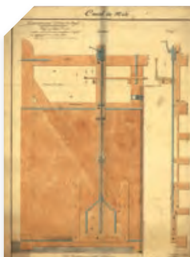
▲ Porte avec vantelle à cric métallique 1827.
