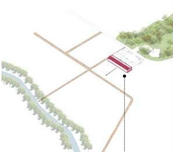
Ne pas orienter les pans de toiture intégrant des panneaux solaires vers le canal
