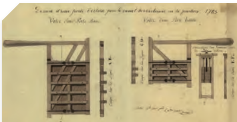
▲ Portes de bois à flèche pour en assurer l'ouverture XVIII ème siècle
